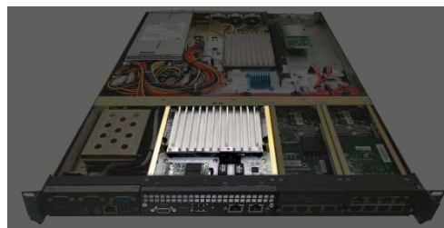
Рисунок 5. Размещение SBC внутри корпуса TSP
